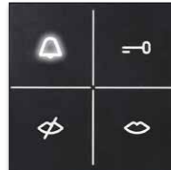
4 Die hinterleuchteten Symbole der Zustandsanzeige zeigen Hörbehinderten, dass es innen geklingelt hat, dass eine Gesprächsverbindung hergestellt oder der Türöffner betätigt wurde.
